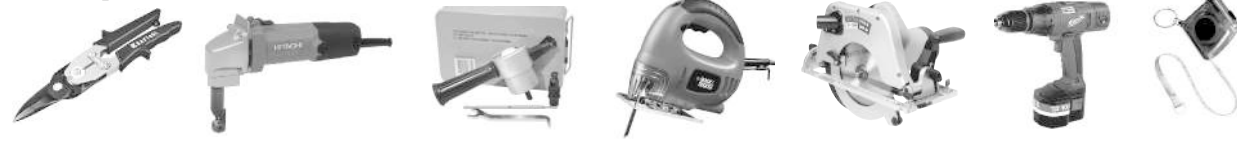
1. Металл кесадиган қўл қайчилари 2. Электр қайчи 3. Пармадастага ҳўрак учун кески металлчи 4. Электр қил арра 5. Тишлари қаттиқ қотимладан ясалган гардиш арра 6. Бурама миҳ қотирғич 7. Латта тасмали рулетка
